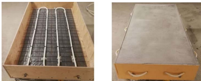
Рисунок 2. Вид экспериментальной модели одежды ездового полотна до и после заливки пескобетоном (фотографии сделаны авторами)
